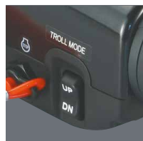
トロールモードスイッチ ・トロール時のエンジン回転数を アイドリング時から1200rpmまで、 50rpm刻みでアップできます。
