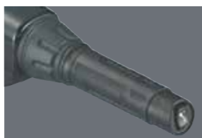
パワートリム&チルト (PTT) スイッチ/ スロットルアジャスター
