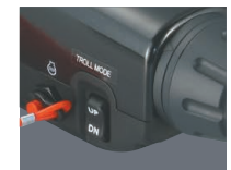
トロールモードスイッチ トローリング時のエンジン回転数をアイドリング時から1200rpmまで、50rpmきざみでアップできます。
